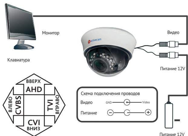
Данная камера имеет три режима работы с разрешением 1Мп: TVI, AHD и CVI, а также режим аналогового видео стандарта CVBS (PAL 960H) с разрешением 700ТВЛ. По умолчанию камера работает в стандарте TVI. Для переключения в другие режимы удерживайте в течении 5 сек кнопку OSD-джойстика в соответствующем направлении.
